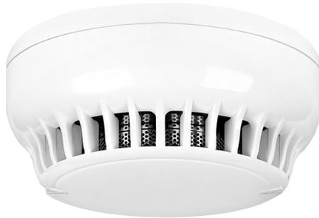
Le détecteur de fumée optique conventionnel TFD-4230 est conçu pour assurer une protection maximale dans les espaces de petite et moyenne taille grâce à sa technologie de détection optique avancée. Le détecteur a développé une série d'algorithmes afin de minimiser les fausses détections et d'avertir en cas de contamination. La chambre de fumée peut être facilement nettoyée en cas de contamination.
