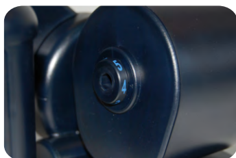
Lochblendenposition 4 Reichweite von 15 m bis 120 m
