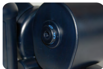
Lochblendenposition 5 Reichweite von 10 m bis 50 m
