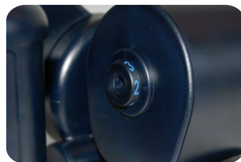
Lochblendenposition 2 Reichweite von 30 m bis 90 m
