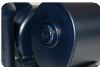
Lochblendenposition 4 Reichweite von 15 m bis 65 m
