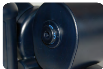
Lochblendenposition n 5 Reichweite von 10 m bis 80 m
