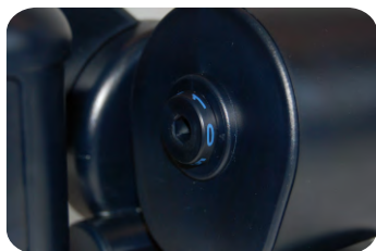
Lochblendenposition 0 Reichweite von 20 m bis 150 m
