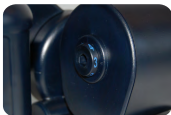
Lochblendenposition 3 Reichweite von 30 m bis 150 m
