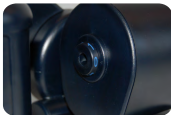
Lochblendenposition 0 Reichweite von 30 m bis 200 m
