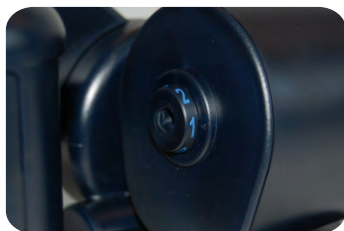
Lochblendenposition 1 Reichweite von 50 m bis 180 m
