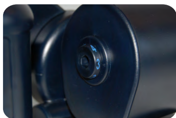
Lochblendenposition 3 Reichweite von 20 m bis 80 m
