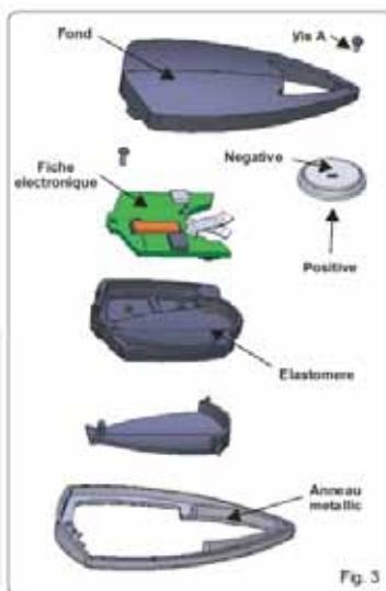
Pour accéder au pile à l'aide d'un tournevis dévisser la vis A (Fig. 3) qui se trouve à l'arrière de l'émetteur et enlever le couvercle. Remplacer l'ancienne par la nouvelle de même type (CR2032). Placer le pôle négatif de la pile en haut (Fig.3).
