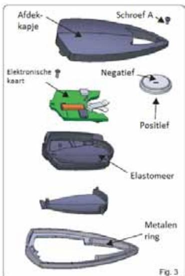
Om de batterij te vervangen draai schroef A aan de onderkant (fig. 3) los met een schroevendraaier en verwijder het afdekkapje. Vervang de lege batterij door een nieuwe van hetzelfde type (CR2032). Plaats de batterij met de negatieve pool naar boven (fig. 3).
