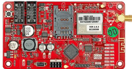
Le TXM-5474 est un module LTE (4G) qui peut être intégré dans les centrales d'incendie adressables TEKNIM (TFP-121x). Une centrale TEKNIM équipée du module TXM-5474 peut communiquer avec une salle de télésurveillance via les réseaux GSM (4G). De plus, cette connexion au réseau GSM permet également la configuration à distance de la centrale TEKNIM à l'aide de l'application TEKNIM et de la page web MOSAIC.
