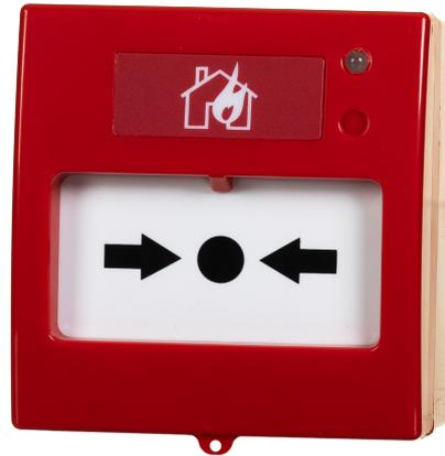
Le TWB-1866 est une alarme incendie manuelle sans fil qui sert à donner un avertissement manuel en cas d'incendie. Il communique entièrement sans fil avec le récepteur sans fil. TWB-1866 peut fonctionner pendant 4 ans avec une pile ou 8 ans avec deux piles. Il prend en charge le fonctionnement avec réinitialisation et un couvercle de protection supplémentaire peut être installé pour éviter les situations qui provoquent de fausses alarmes.
