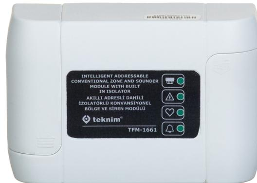
Le module de zone et de sirène adressable TFM-1661 est conçu pour être utilisé avec la série de panneaux de commande adressables TFP-12XX. Il permet d'utiliser des dispositifs conventionnels dans un système adressable, qui peuvent transmettre des informations d'alarme et de défaut par la boucle et fournir une sortie de sirène. Le module est équipé d'un isolateur de court-circuit intégré pour protéger la boucle des courts-circuits.
