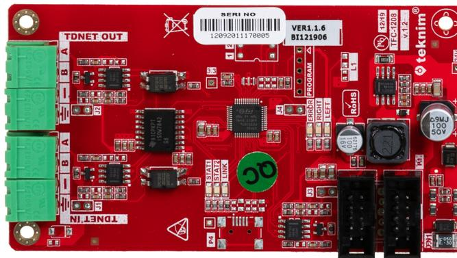
Le module réseau TFC-1209 forme un réseau solide en anneau ou en bus en interconnectant 16 panneaux via le protocole TdNET. Il a d'un isolateur intégré qui permet de sécuriser la ligne réseau en cas de court-circuit du câble entre les panneaux de commande.
